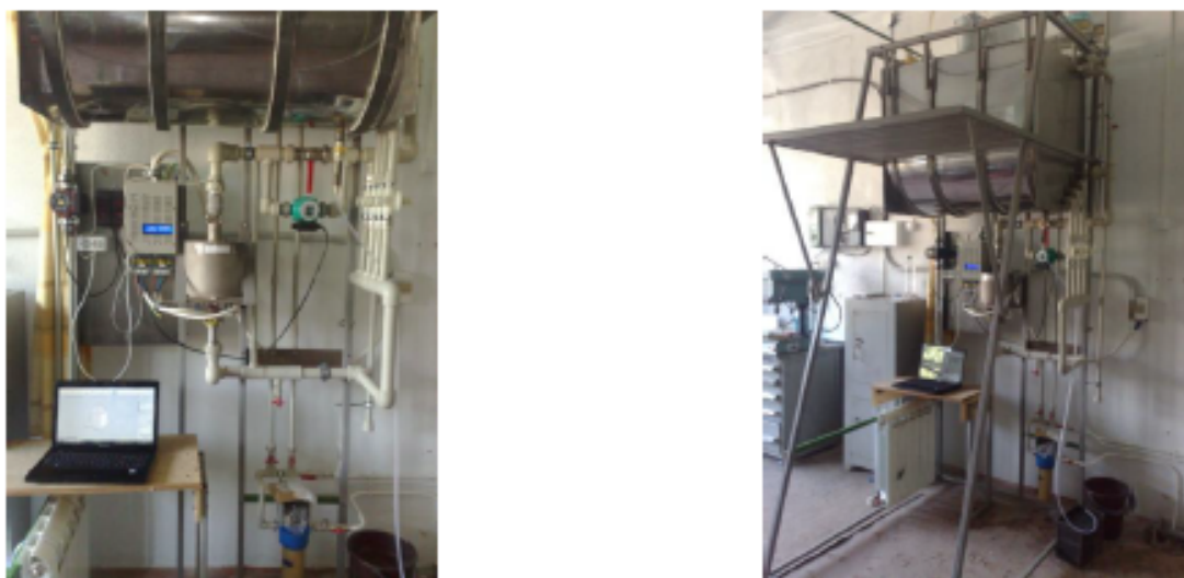
Рис. 1 – Загальний вигляд установки для дослідження теплоакумулятора
